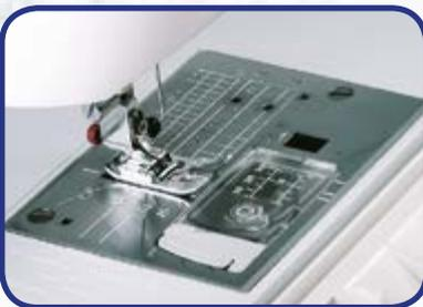
Die Spulenschnelleinlage sorgt für einen schnellen Start beim Nähen. Spule einlegen, Faden in die Führung ziehen und abschneiden. Abdeckung drauf und los geht es. Die klare Abdeckung lässt immer den Blick auf die Menge des Spulensfadens zu.
